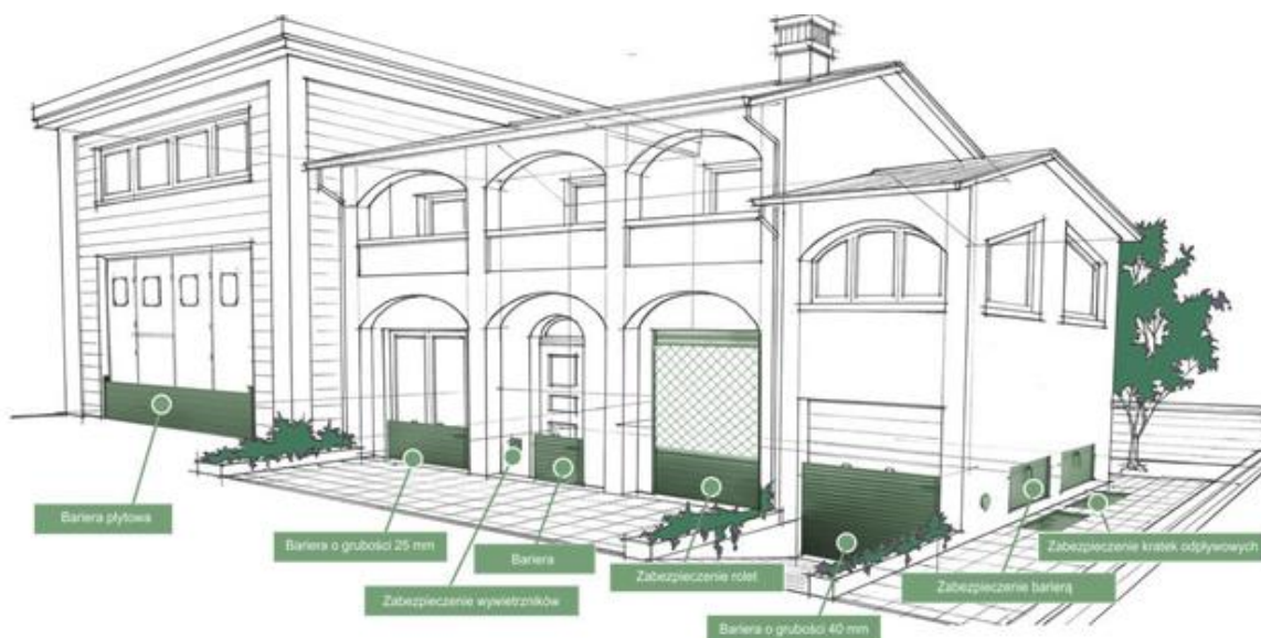
Rys. 40 Przykład zastosowania grodzi przeciwpowodziowych w budynku.
