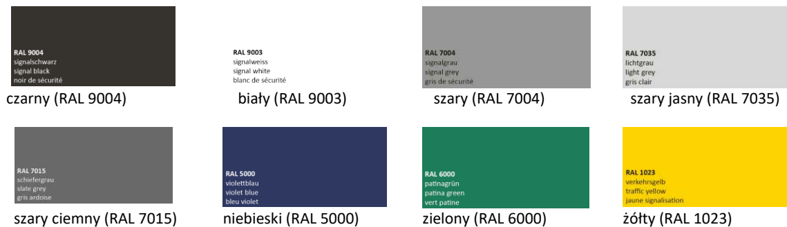
Rys. 1. Wybrana kolorystyka elementów kontrastowych oznakowania dotykowego.
